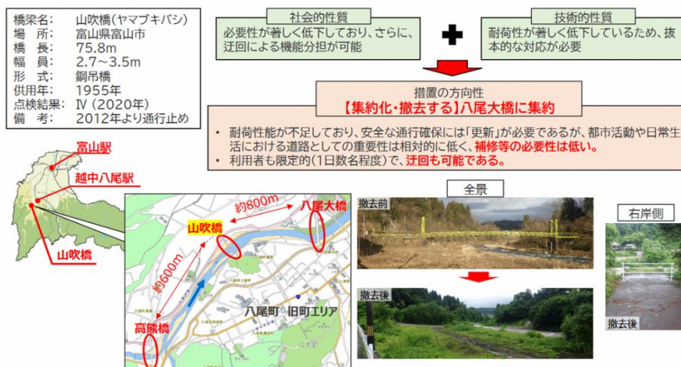
図表 3 橋梁トリアージの取組例－山吹橋の撤去－
