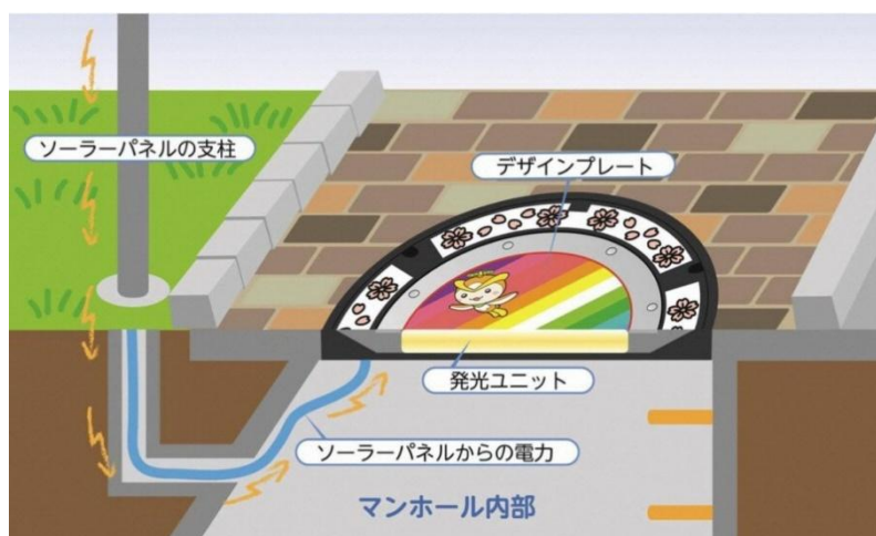
図表 3 イルミネーションマンホール蓋発光の仕組み
